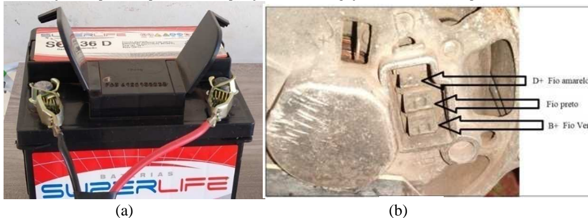
Figura 7 – Imagem fotográfica apresentando (a) uma das extremidades dos fios vermelho e preto, acoplado aos terminais de engate rápido, já colocados na bateria. (b) os plugues de ligação do alternador automotivo utilizado na confecção do aparato experimental e a posição correta da ligação dos fios amarelo, preto e vermelho.
