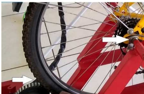
Figura 4 – Imagem fotográfica da bicicleta aro 26-18V, acoplada corretamente na estrutura metálica pelos pontos de fixação e o alternador automotivo ajustado de forma que a polia encoste no pneu traseiro da bicicleta.
